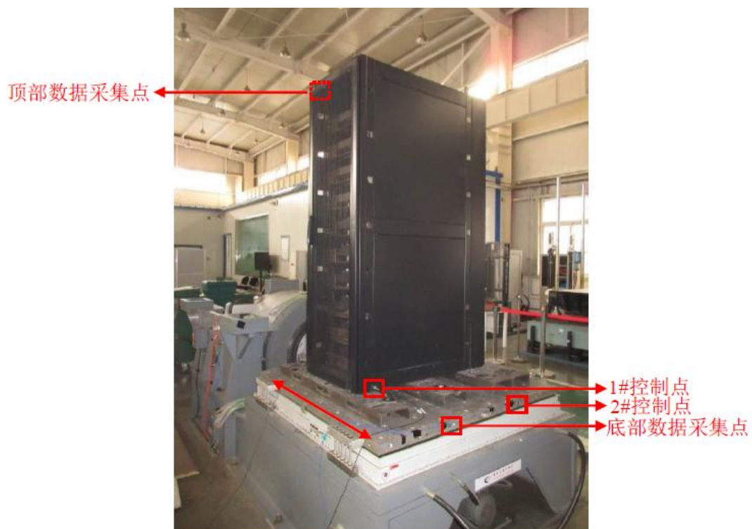
图 5：机柜动态测试现场照片
